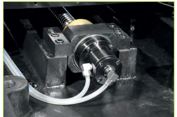
Oliekoeling door kogelomloopspindel (optioneel voor VF1100, VF1300, VF1500)
